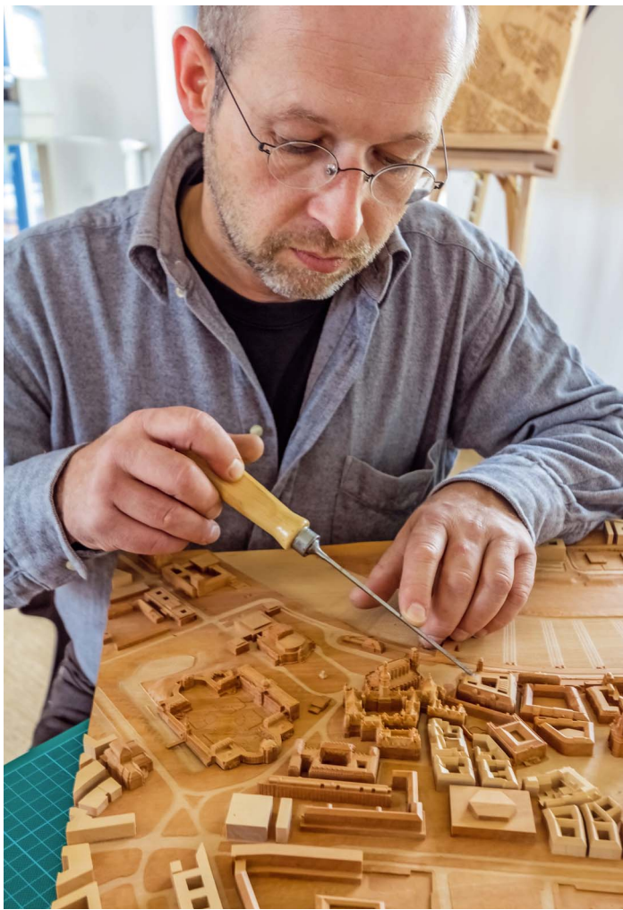
/ Fingerspitzengefühl: Trotz präziser CNC-Bearbeitung fällt noch viel Handarbeit bei der Herstellung von Christian Werners Reliefobjekten an. (Fotos: Scopulus)
