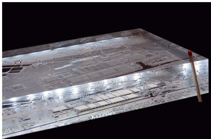
/ Das Modell aus 30 mm starkem Plexiglas zeigt, von unten ins Material eingefräst, das VW-Werk in Wolfsburg im Maßstab 1:20 000. (Fotos: Scopulus)
