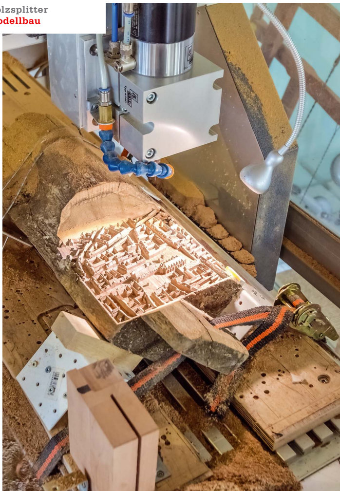
/ Aus dem Vollen gearbeitet: Das Stadtmodell von Braunschweig wurde aus einem historischen Eichebalken ausgefräst. (M 1:3000, Eiche, 20 x 20 cm)
